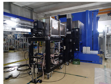
展示物の例 理研に建設中の 小型中性子源 小角散乱装置 (ib SANS)
