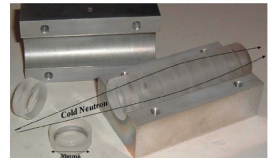
図2 両凹面状に削り出したフッ化マグネシウム屈折レンズ 70枚のレンズで冷中性子 (波長6Å) を焦点距離10mに集光する。
