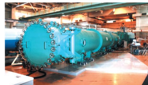
図3 集光型中性子超小角散乱装置 SANS-J-II 下流よりの外観 (左)。中性子集光素子、偏極素子をレイアウトしたコリメータ内部 (右)。
