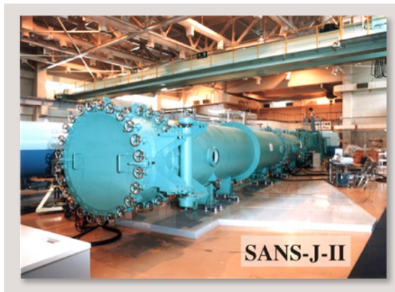
写真1 日本原子力研究開発機構の中性子超小角散乱装置(SANS-J-II) 中性子レンズを使ってナノからマイクロメートルの構造を評価できる
