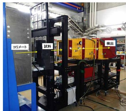
図6 理化学研究所 (埼玉県和光市) の小型パルス中性子源 (RANS) に建設中の小角散乱装置
